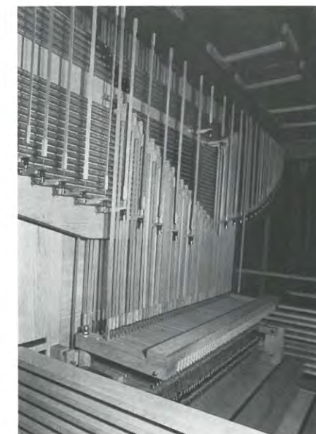
Traktur und Trakturausgleich des Hauptwerkes
